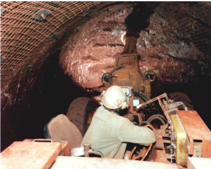
120. ábra. Gépesített jövesztés az indítókamrában
